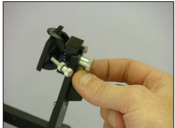
Platzieren Sie den einstellbaren Inzisaltisch und befestigen Sie ihn mit der kleinen Fingerschraube.
